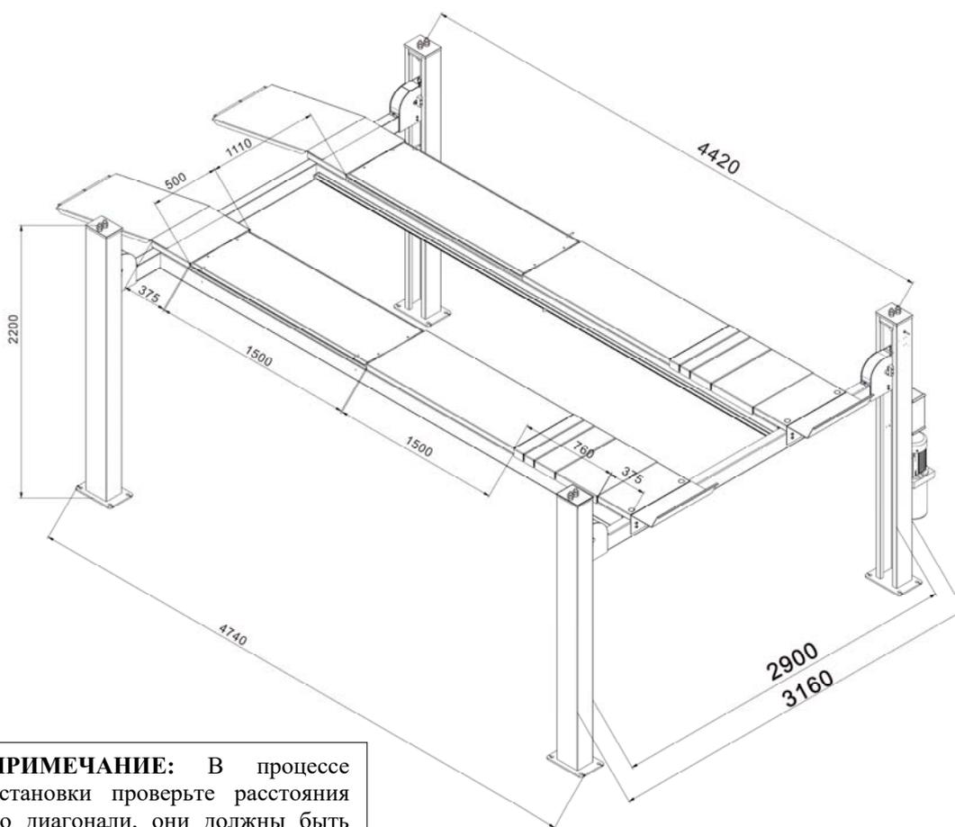
**ПРИМЕЧАНИЕ:** В процессе установки проверьте расстояния по диагонали, они должны быть одинаковыми.
