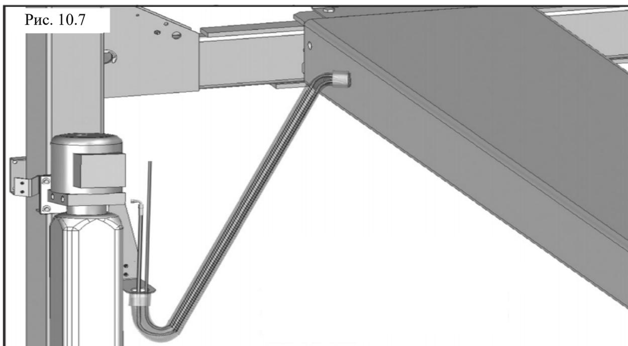
8. Подсоедините гидравлический шланг нагнетательной линии к отверстию нагнетательной линии на агрегате.
