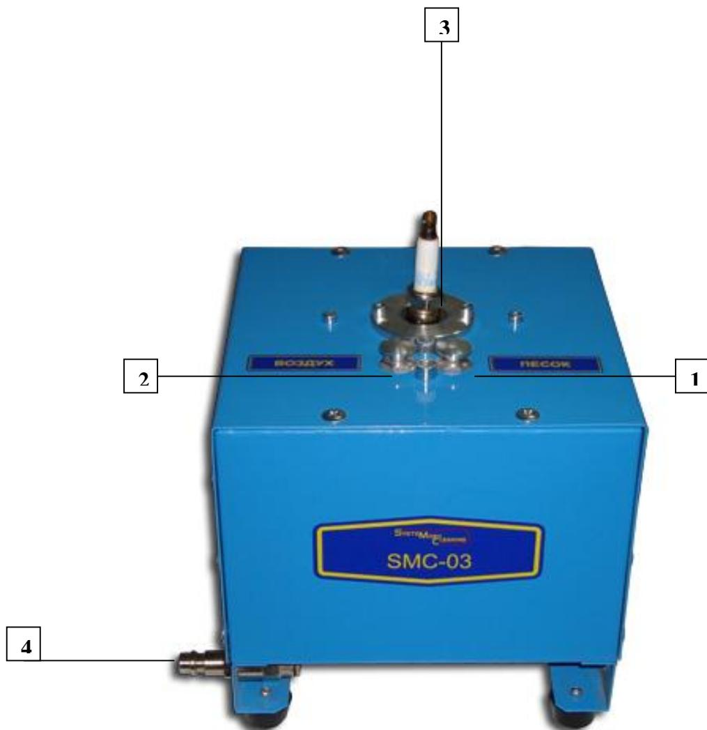
1. Кнопка «Песок» - подача абразивной смеси (включения установки – режима очистки).
