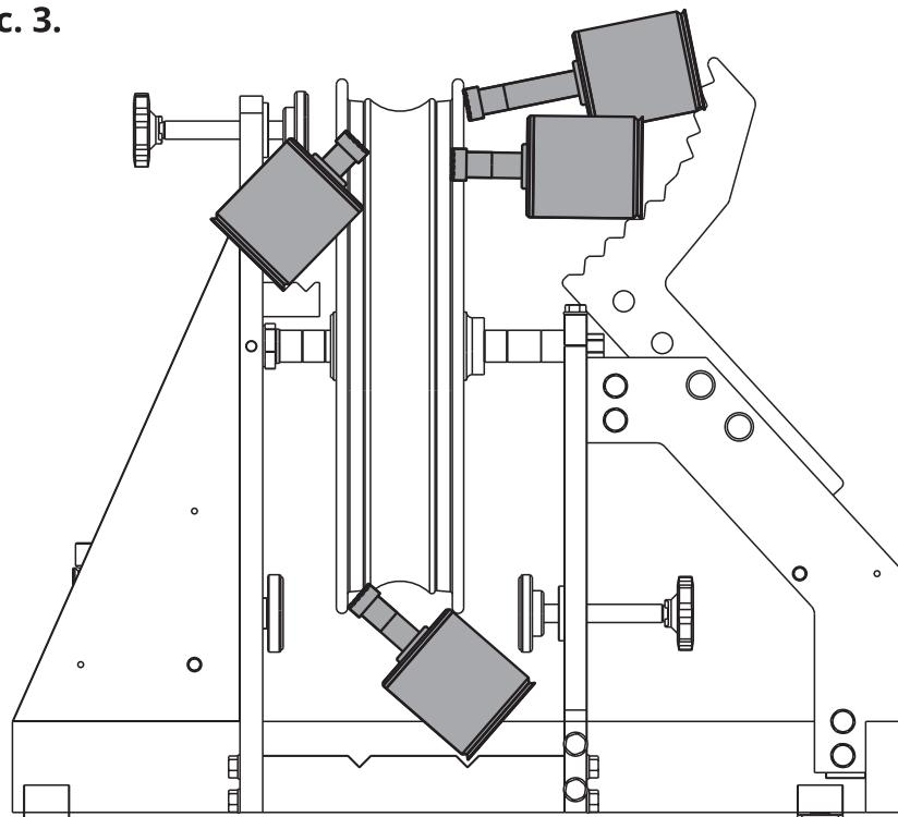
Установку рабочего гидроцилиндра производите в соответствии с рекомендуемыми положениями (см. Рис. 3.).
